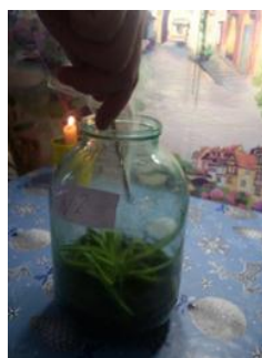
Рис. 7 Доказательство отсутствия в сосуде №2 кислорода сразу после вскрытия: лучина гаснет
